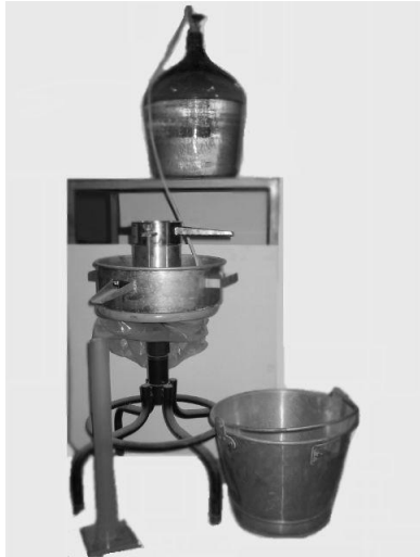
圖 1 透水性試驗儀示意圖
