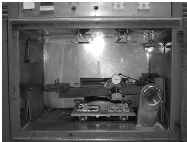
圖 2 輪跡試驗機
