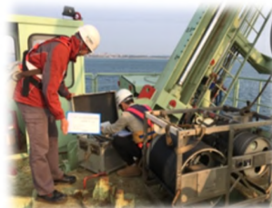
超音波檢測基樁垂直度
