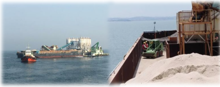
▲ 拌和船移船作業 ▲ 拌和船上備料之機具
