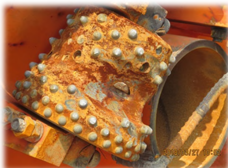
嚴重磨損之RCD鑽頭
