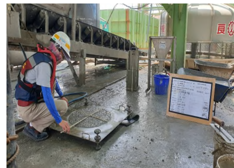
混凝土坍流度試驗
