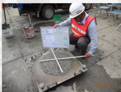
SCC坍流度試驗(90分鐘)
