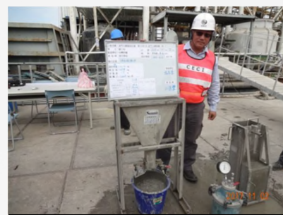
V型漏斗流下時間試驗
