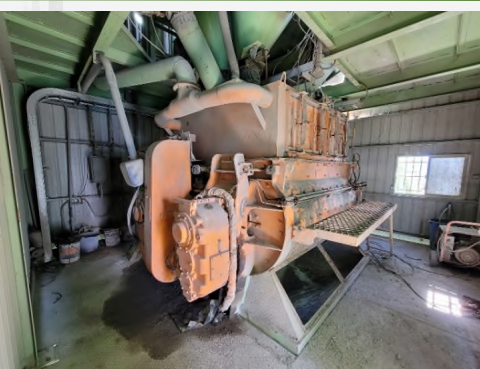
混凝土拌和機(2m³/每盤)
