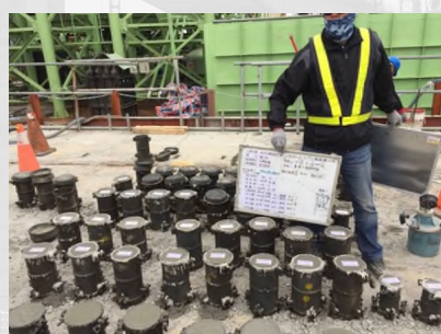
配比試拌圓柱試體製作
