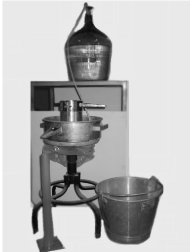
圖 1 透水性試驗儀示意圖
