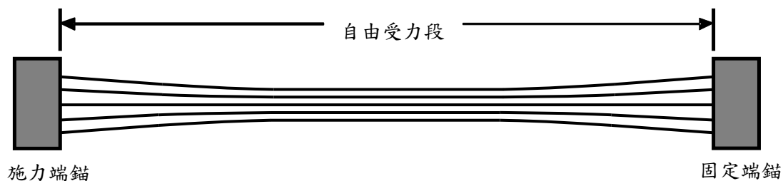
圖1 試驗之預力端錨與鋼絞線組合後幾何構造圖
