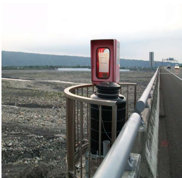
圖 4-27 相對沉陷計水槽設置
