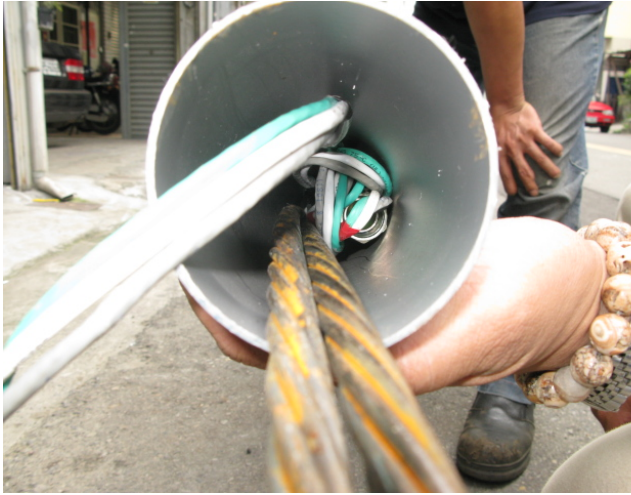
圖 4-22 埋入式沖刷監測儀器線材改良
