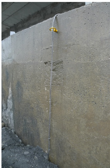
圖 4-10 埋入式沖刷監測儀器架設完成
