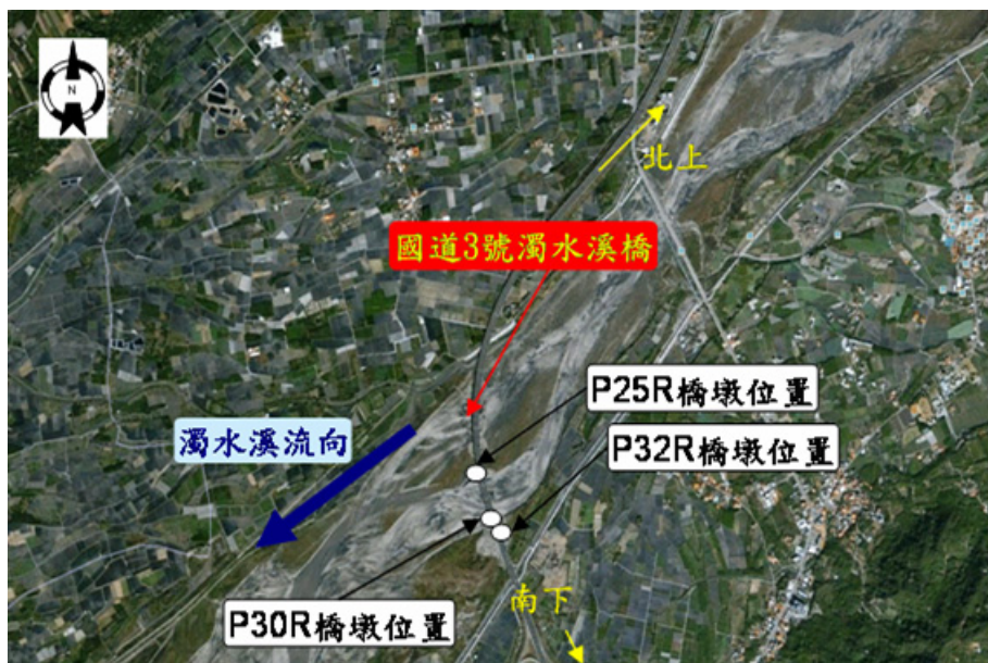
圖 1-2 國道3號濁水溪橋及儀器裝設墩號位置圖
