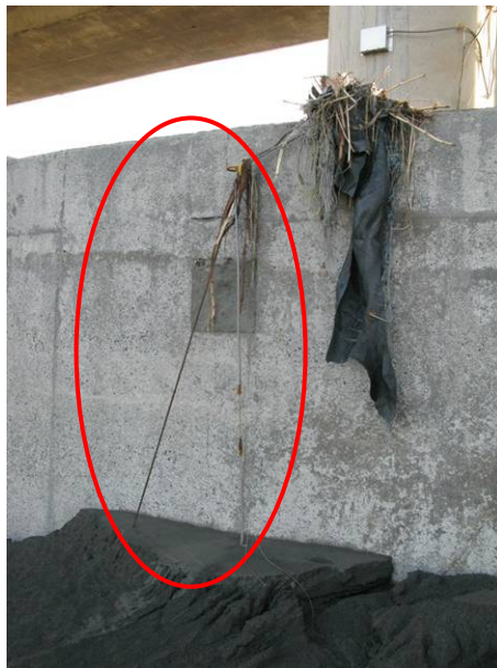
圖 5-1 入式沖刷監測儀器訊號線與鋼索分離被沖毀
