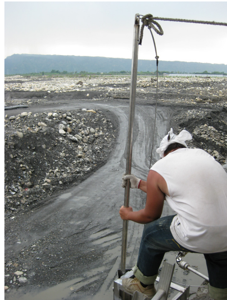
圖 4-13 非埋入式沖刷監測儀器重槌棒
