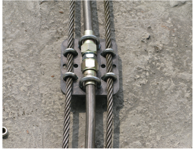
圖 4-23 埋入式沖刷監測儀器結構改良
