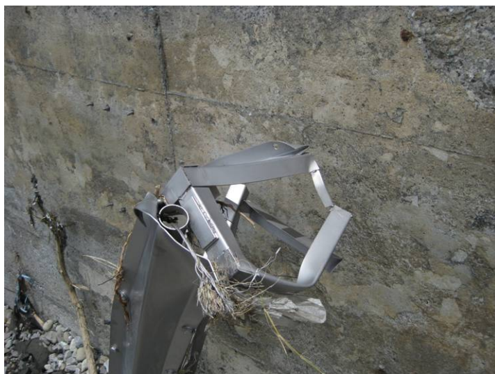
圖 5-2 非埋入式沖刷監測儀器破壞
