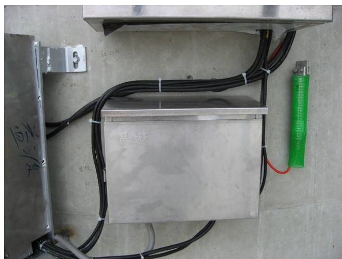
圖 4-25 傾斜計安裝完成
