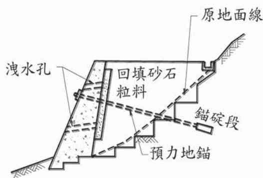
圖 4.101 地錨加固工法示意圖
