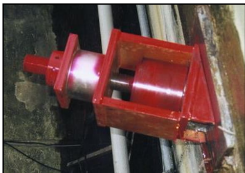
圖 5-6 荷重計示意圖
