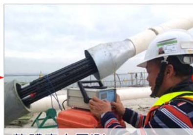
整體索力量測 (EM Sensor) 39
