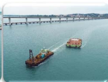
拖船搭配平台船進行運補
