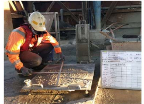
拌和船取樣作業
