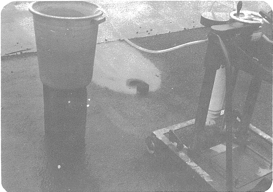
圖 22 以鑽機鑽取試體
