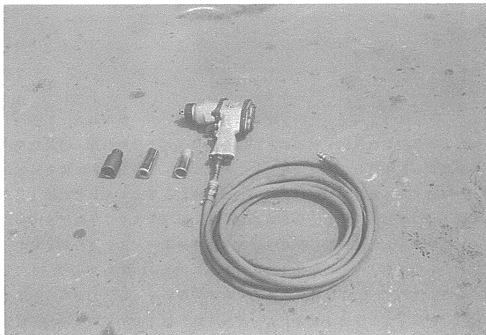
圖 8 - 2 - 28 人工配合機械拆解使用之氣動扳手零組件
