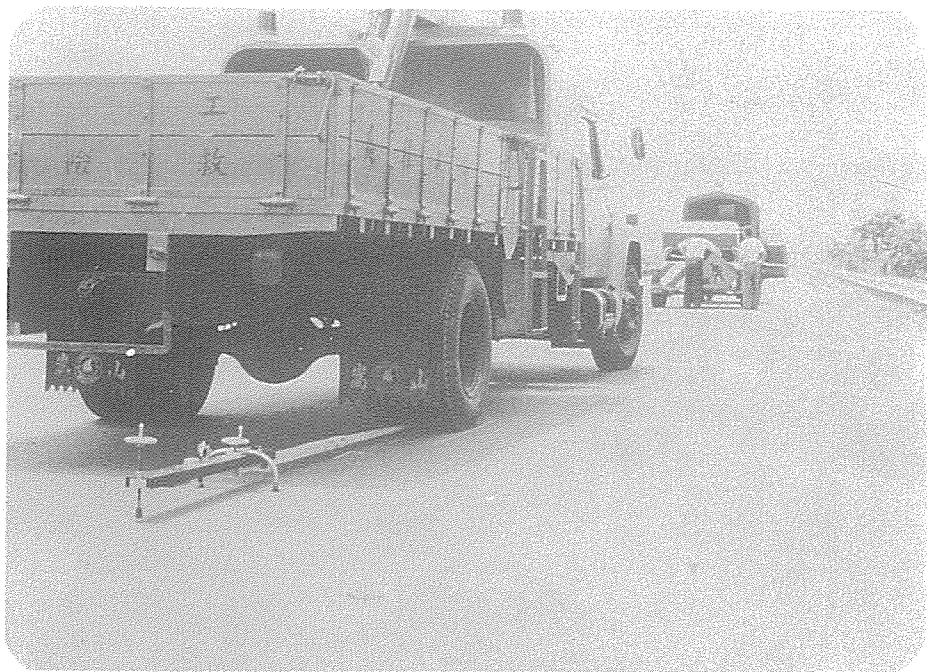
圖 8 - 5 - 12 鋪築前原路面 Road Rater 及 Benkelman Beam 撓度測試
