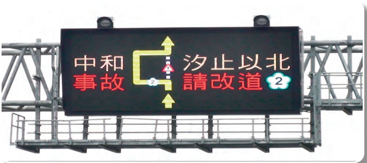
全彩資訊可變標誌一路徑導引
