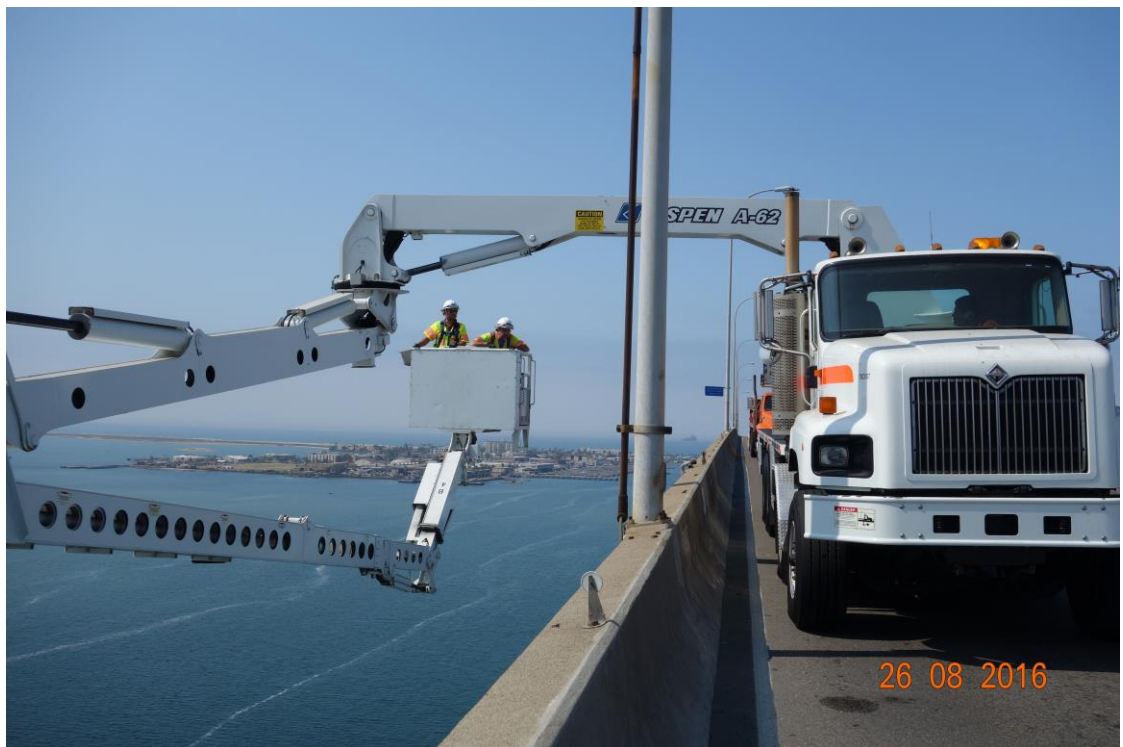
圖三十六 San Diego Coronado 橋梁檢測使用橋檢車
