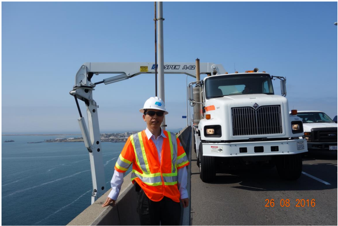
圖三十六 San Diego Coronado 橋梁檢測使用橋檢車
