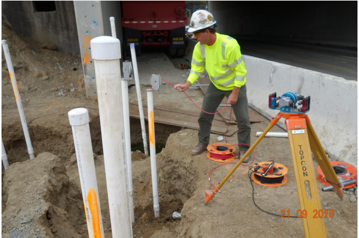
圖五十七 10號高速公路拓寬工程基樁超音波檢測
