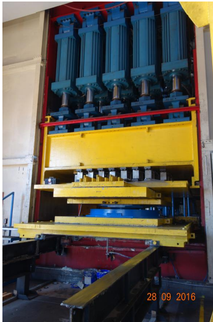
圖三十 摩擦單擺支承性能測試
