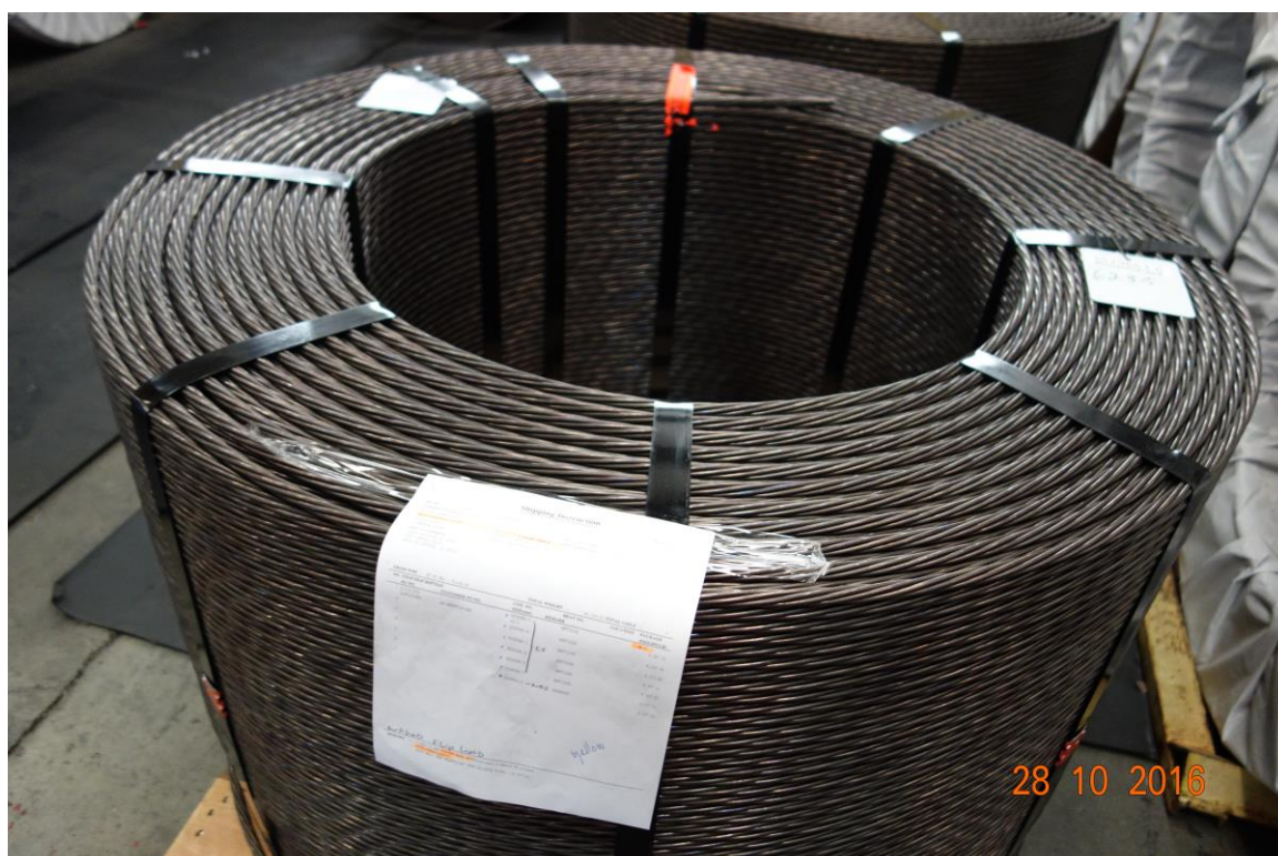
圖七十四 會同Caltrans工程師至工廠驗收鋼絞索
