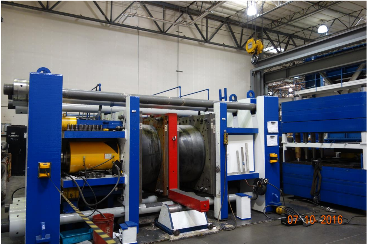
圖三十三 鉛心橡膠支承性能測試
