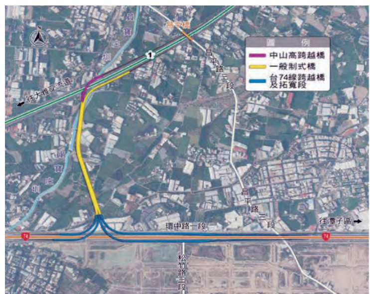
國道 1 號臺中路段增設銜接台 74 線系統交流道工程示意圖
