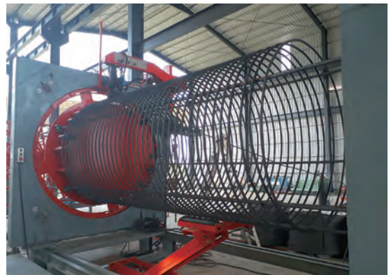
第 C715 標 箍筋籠成型加工
