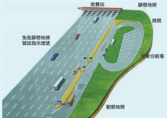
圖 5-12.3 國道 3 號動態地磅布設示意圖
