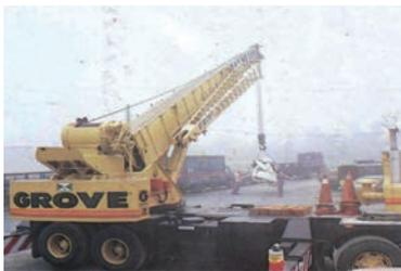
圖 5-29.1 50 公噸大型起重機用於事故處理情形
