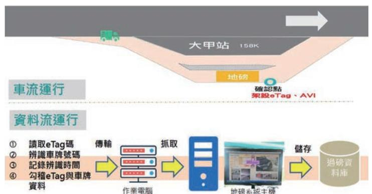
圖 5-12.6 大甲地磅站設備配置及運作原理
