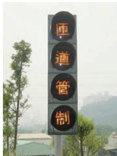
圖 5-25.7 「匝道管制」警告標誌板
