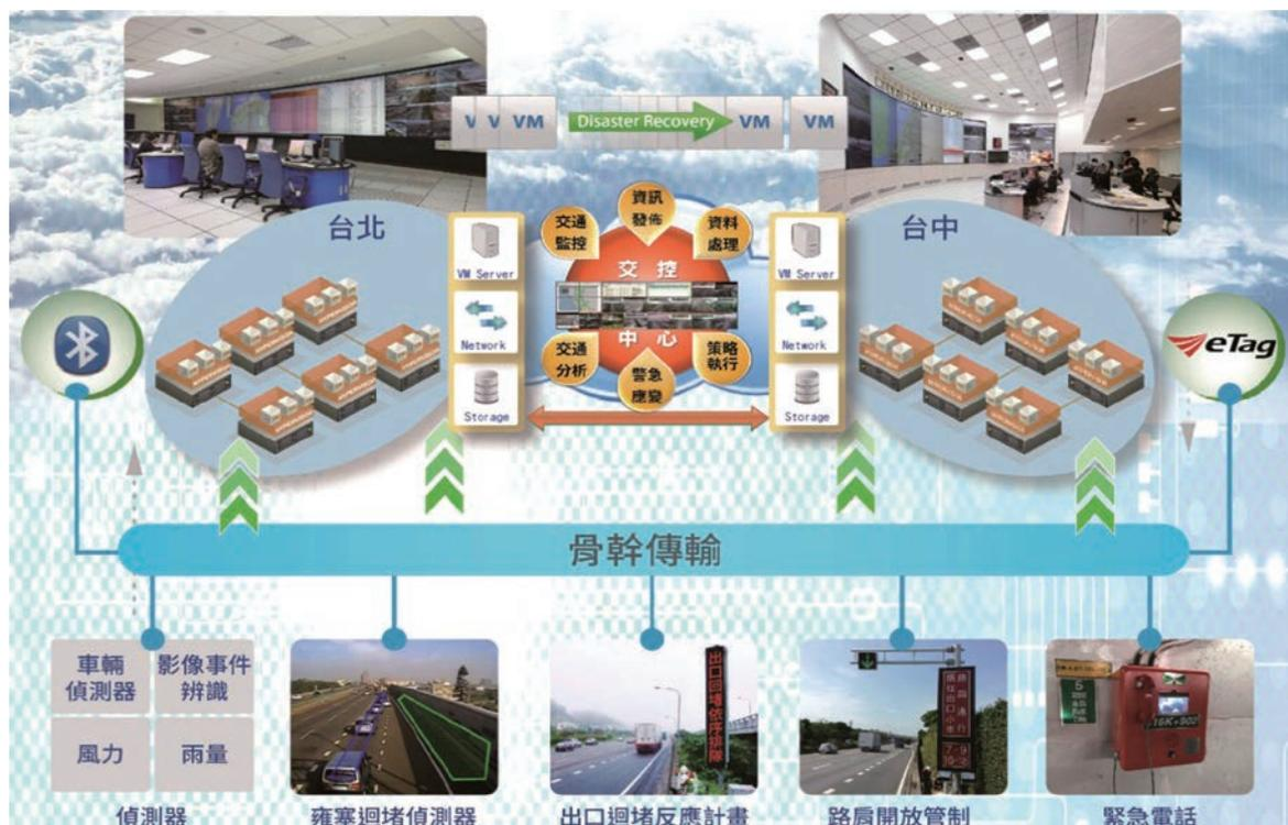
圖 5-23.11 第四代中央電腦系統雲端服務架構圖
