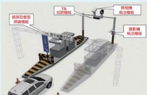
圖 7-3-4.2 計次階段 ETC 前端系統架構
