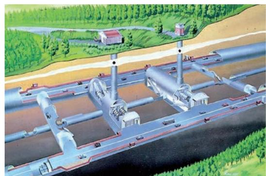
圖 5-26.5 雪山隧道軸流式風機配置圖
