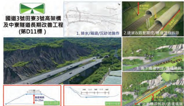
圖 3.33 第 D11 標 施工示意圖
