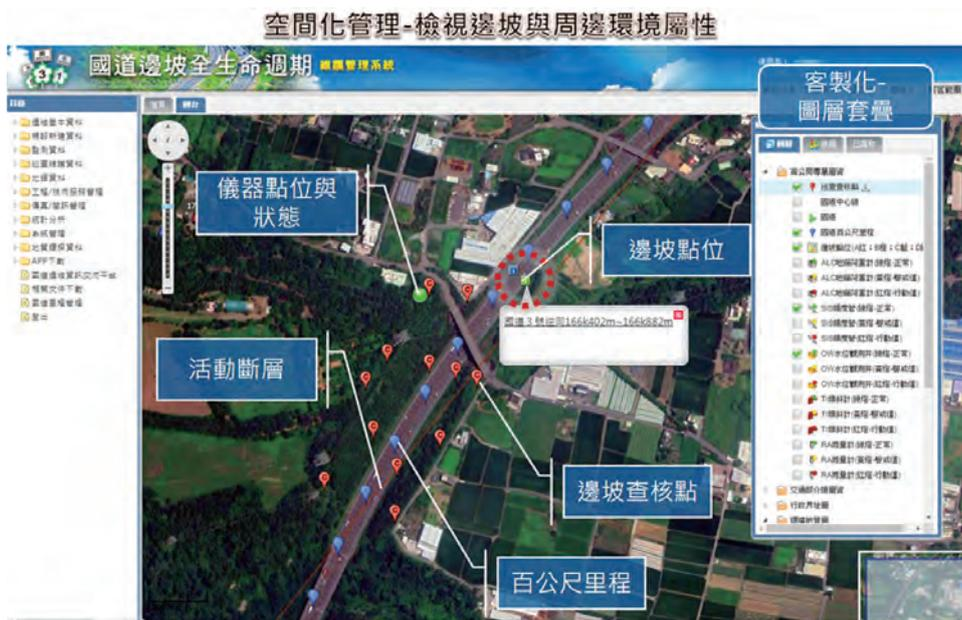
圖 4.25 國道邊坡全生命週期維護管理系統圖臺畫面
