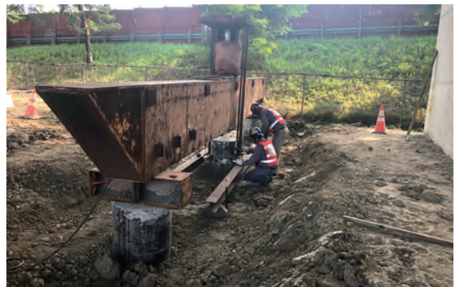
圖 3.104 第 M37G 標 鋼管樁試樁作業 (拉力樁)
