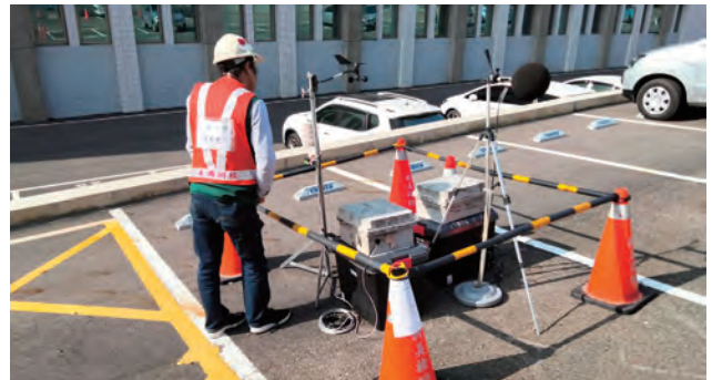
圖 3.128 第 M38C 標 施工前環境監測噪音振動
