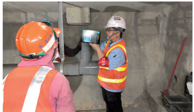
圖 3.78 箱型梁腹板鋼筋掃描作業
