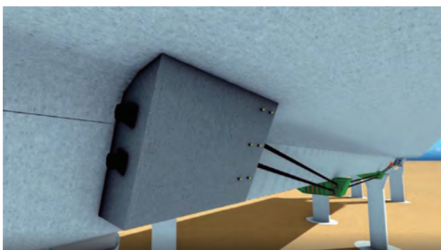
圖 3.120 第 M38B 標 外置預力及錨定座示意圖
