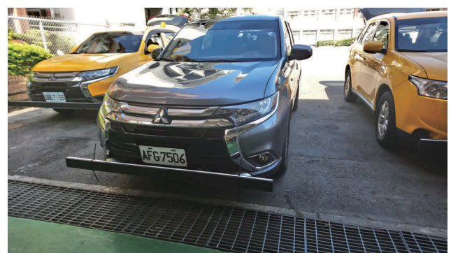
圖 3.9 本局新購入之慣性式雷射剖面儀檢測車
