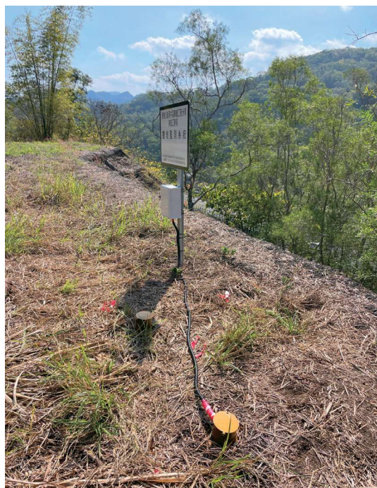
圖 3.12 人工量測提升至自動化之水位觀測井 (OW)
