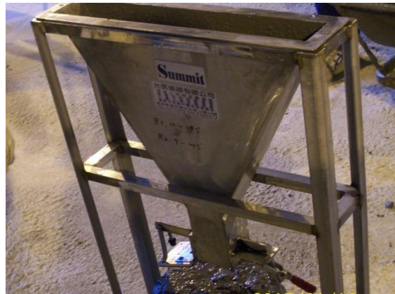
圖 2-6 下構 350 SCC 配比箱型試驗及 V 漏斗試驗情形
