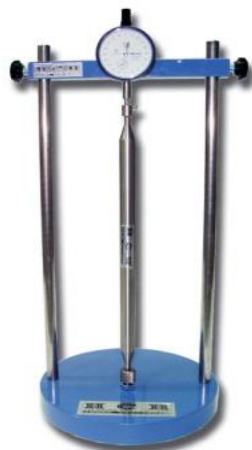
圖 4-1 混凝土乾縮設備及量測示意圖
