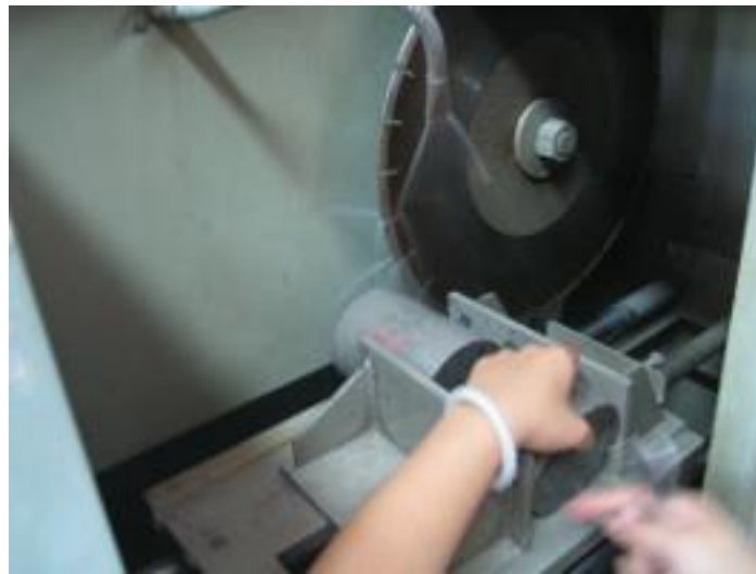
圖 5-1 試體切割機內部構造及切割情形
