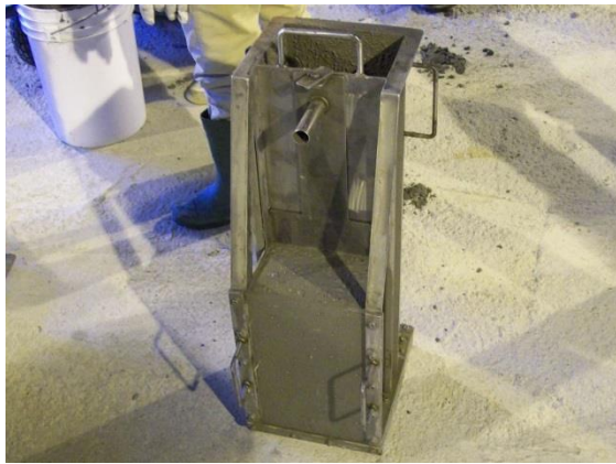
圖 2-6 下構 350 SCC 配比箱型試驗及 V 漏斗試驗情形
