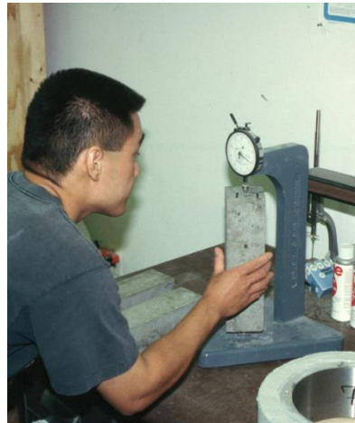
圖 4-1 混凝土乾縮設備及量測示意圖
