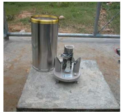
圖 5-11 雨量計示意圖
