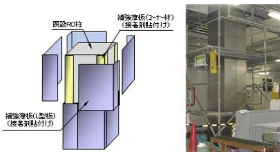
薄板多層巻き耐震補強工法
