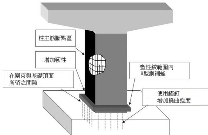
圖 3. 鋼板圍束補強使用錨釘示意圖〔UNJUH 2008〕
