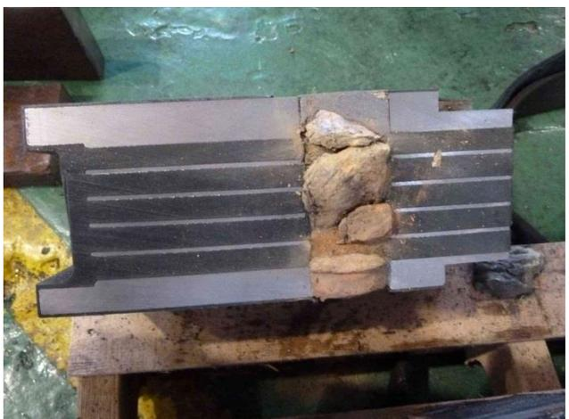
圖十一. 在圖九(a)中鉛心棒受損狀況
