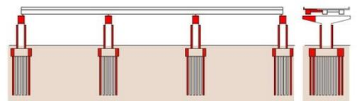
傳統橋梁拓寬工程施工法
