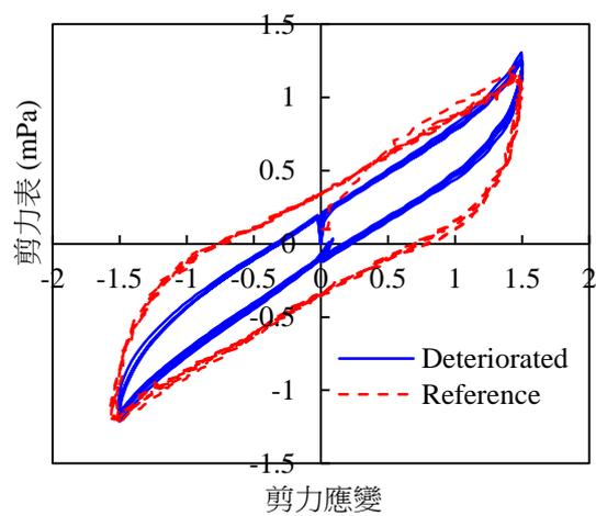
圖十. 受損鉛心支承座殘餘耐震性能 (圖九. (a)中以 150%的剪力變形極值)
