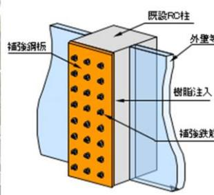
(d) One side shear capacity enhancement method
