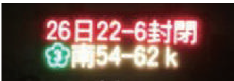
圖 3.6-11 CMS 顯示之施工資訊預告（包含預計施工日期及位置）
