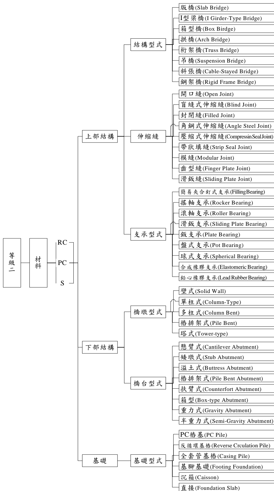
圖 4.13 橋梁結構型式欄位表
