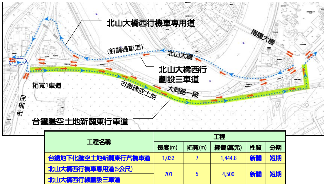
圖 5.4-6 汐止區大同路民權路南港路口行車動線佈設示意圖
