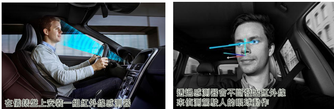
圖 5.5-7 紅外線眼球偵測系統示圖示
