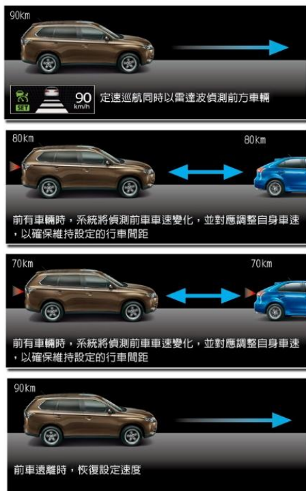
圖 5.5-11 跟車雷達系統示意圖
