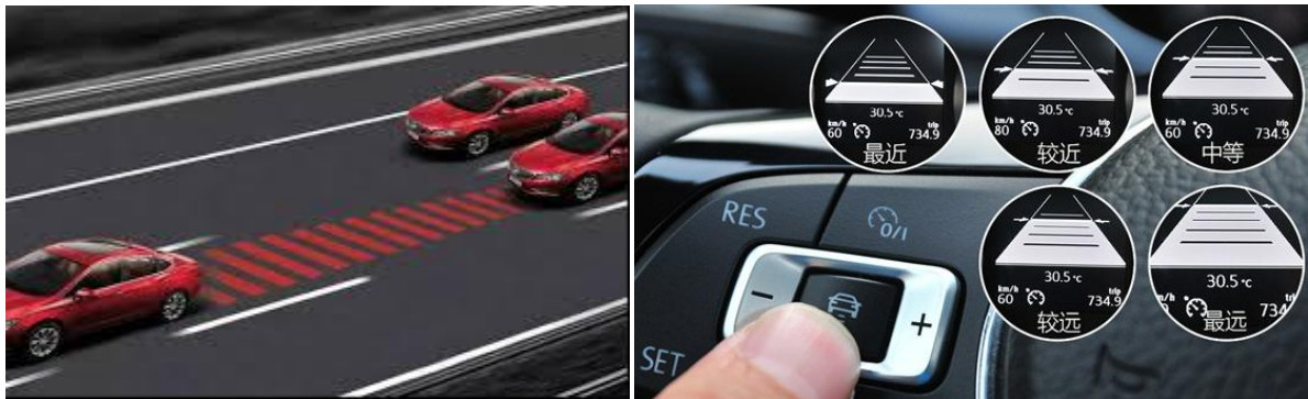
圖 6.2-7 ACC 主動車距控制巡航系統示意圖
