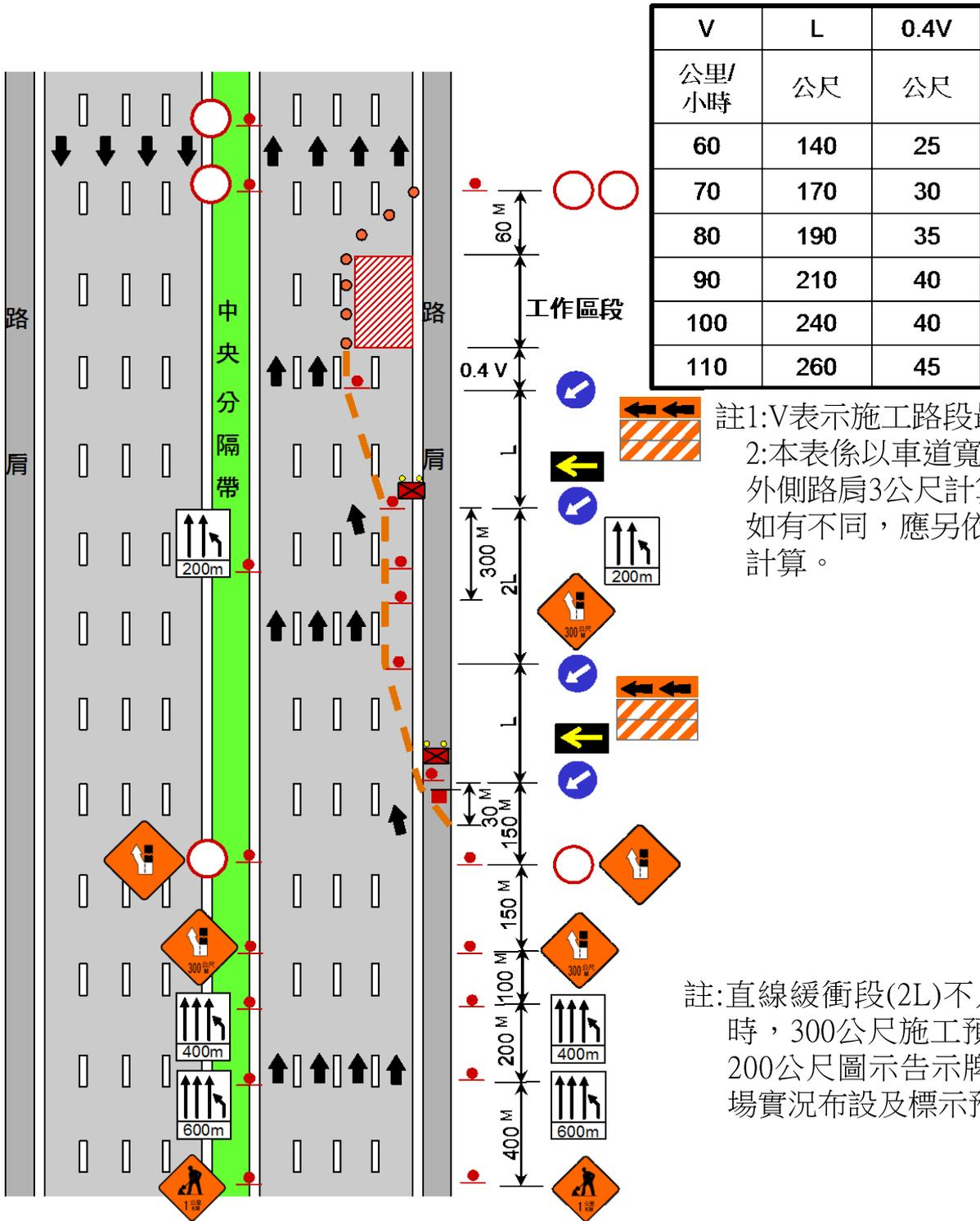
註1: V表示施工路段最高速限
