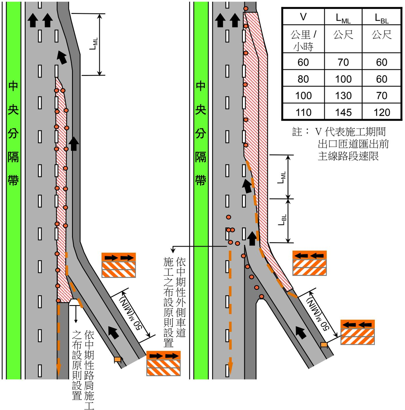
4. 交流道加速車道及主線外側車道同時施工
