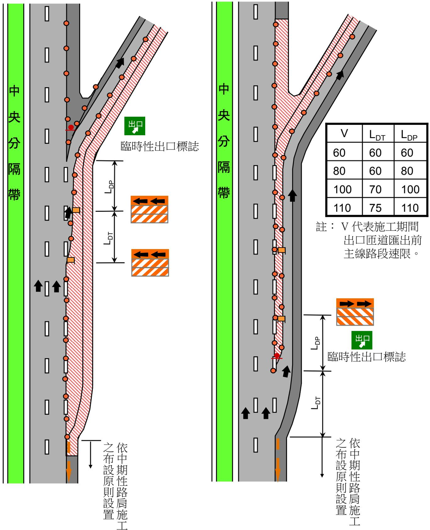
2. 交流道減速車道及主線外側車道同時施工
