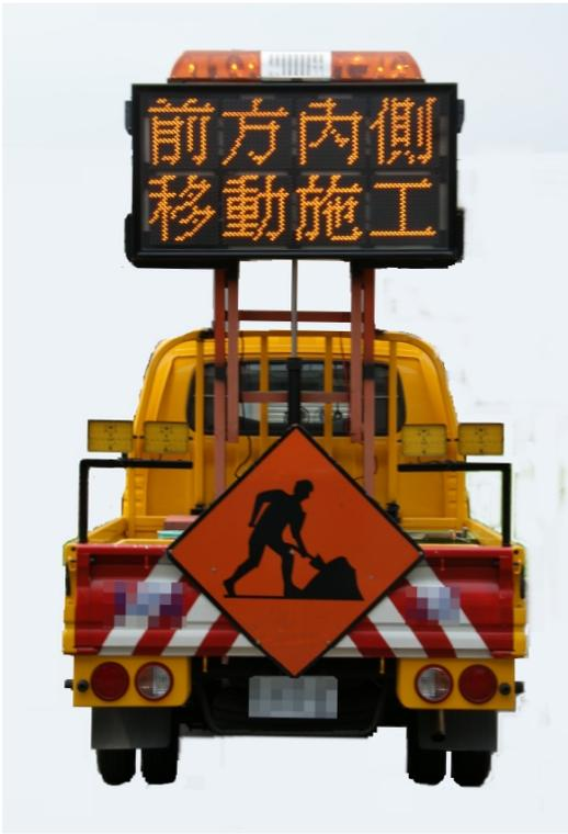
標誌車載式移動式 LED 標誌板相片例
