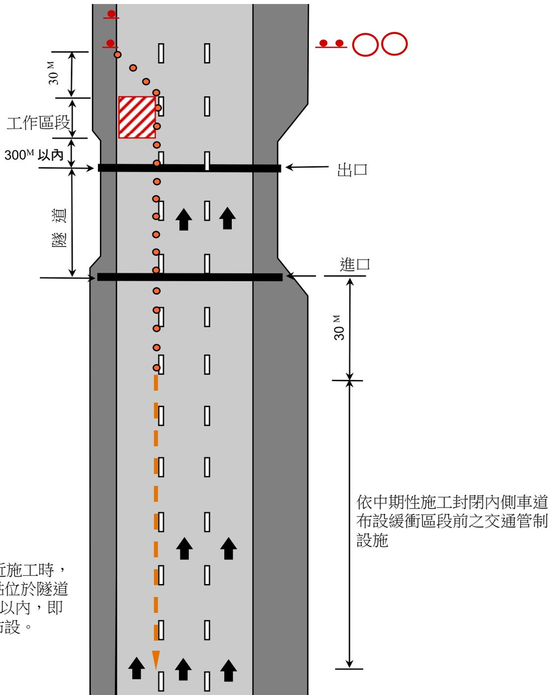
註：隧道出口附近施工時，工作區段起點位於隧道出口300公尺以內，即應依此原則布設。
