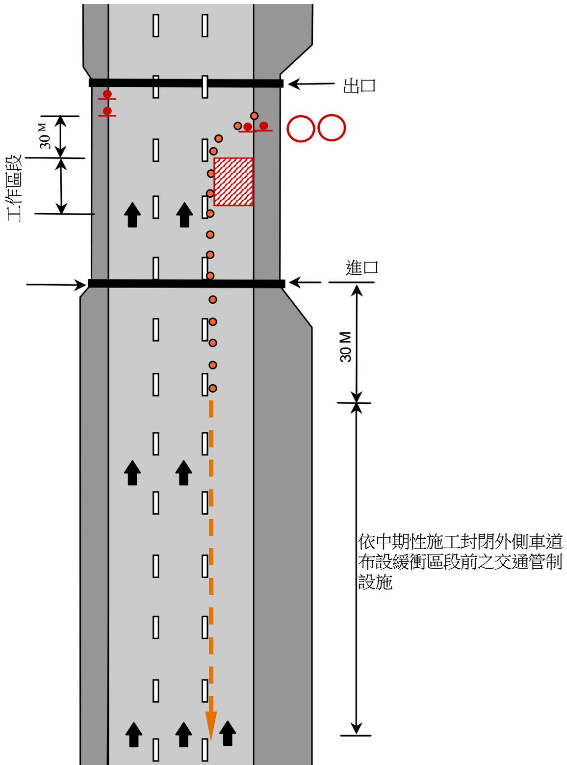
5. 同向三車道以上之多車道，隧道出口附近內側二車道施工
