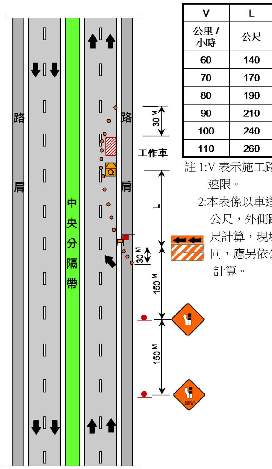
註 1: V 表示施工路段最高速限。
