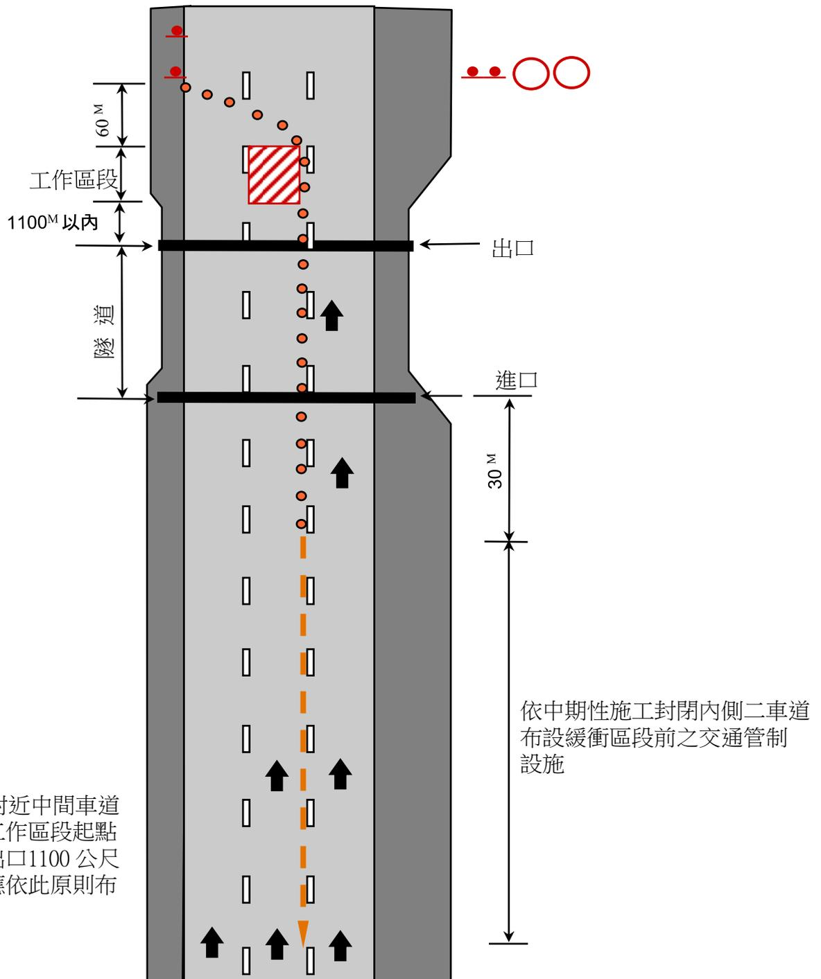
註：隧道出口附近中間車道施工時，工作區段起點位於隧道出口1100公尺以內，即應依此原則布設。
