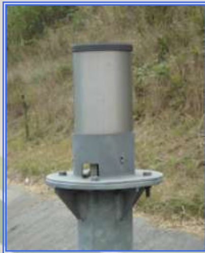
雨量偵測器(RD)
