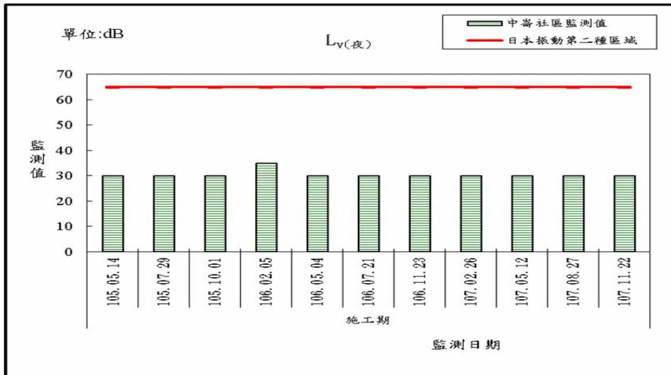
圖 2- 53 中崙社區振動監測結果比較圖 (L<sub>v</sub>夜)
