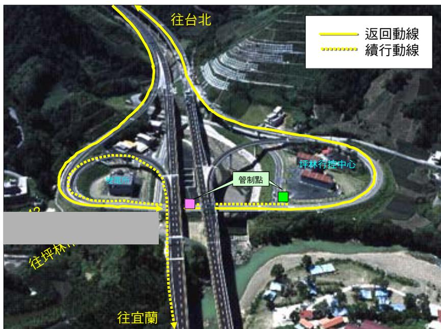
圖 5.3.3-3 匝道繞行動線示意圖(台北往宜蘭)
