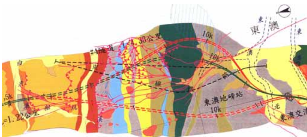
圖五、東部國道四號隧道路線調整圖
