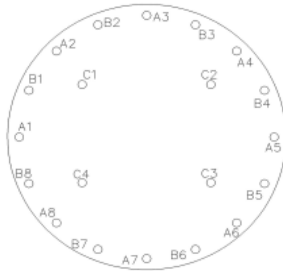
圖五 三號豎井 L.W 灌漿孔配置圖
