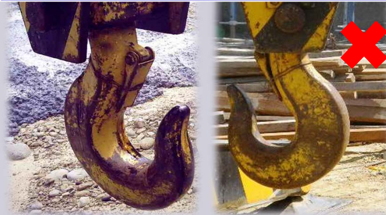
吊鉤防脫裝置被惡意固定失去功能
