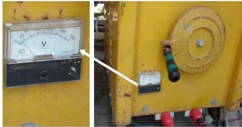
交流電焊機之內藏式自動電擊防止裝置設置電壓指示表。 自動電擊防止裝置發揮作用時，電壓指示表指示之為安全電壓(25V)以下。
