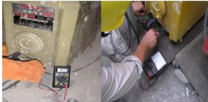
以攜帶式三用電表(多功能量測電表)測量交流電焊機二次側之電壓。
