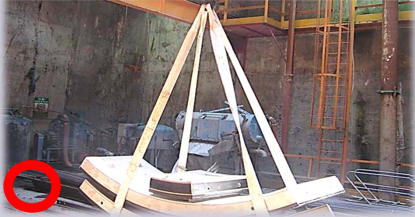
吊索、吊帶應正確鉤掛於吊鉤
