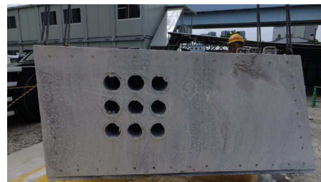
模擬試験体の切断面における充填性確認
