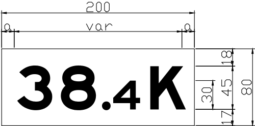
(W-W/G) FT-6-33-2 本標誌設於CMS門架左上方橫桿 里程數為十位數採寬200cm設計
