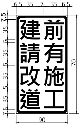
施工建請改道預告臨時牌面
