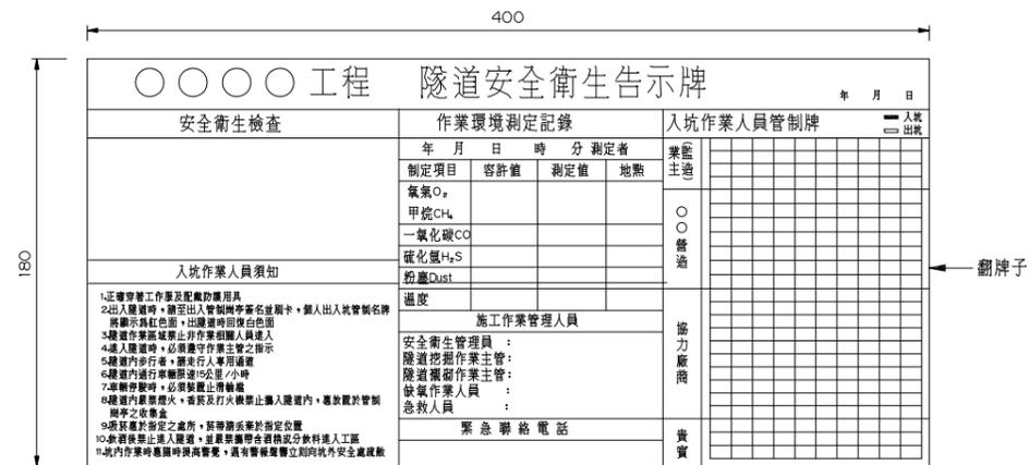
A-1 隧道洞口安全衛生告示牌示意圖 (一般面板)
