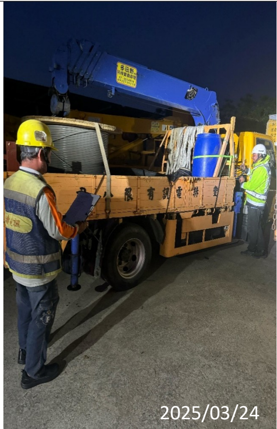
吊掛作業機具、人員須具有合格一機三證資料 (移動式起重機、操作人員以及吊掛人員合格證檢查)
