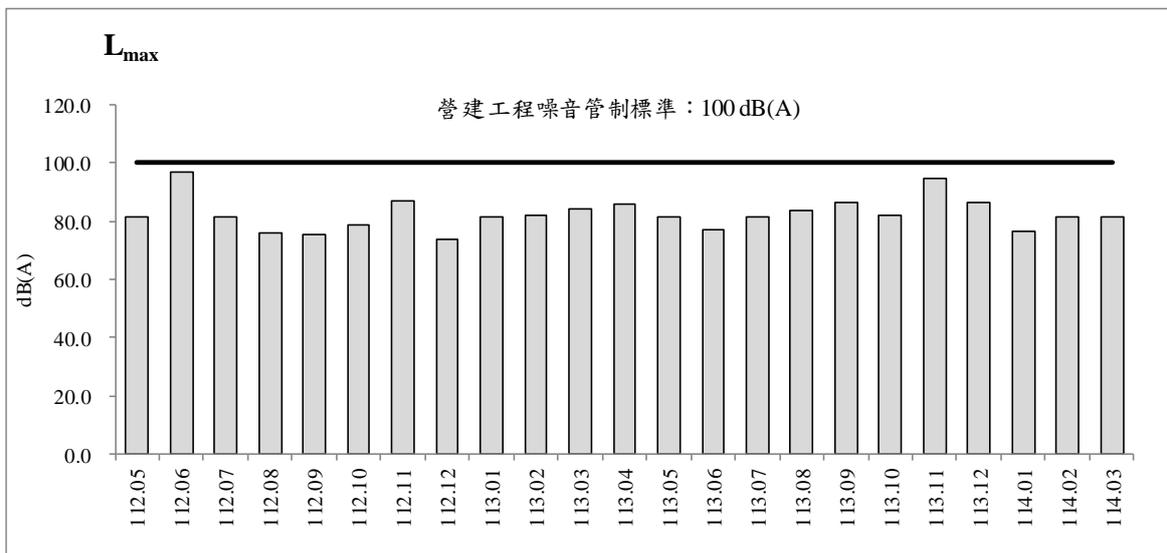
圖 2.4-1 歷次營建工程噪音監測之各項測值變化圖
