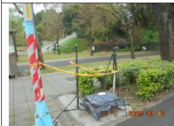
環境噪音振動監測 (土城醫院)
