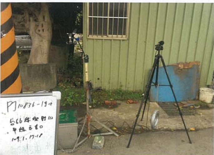
噪音振動監測站 台 66 線與縣 112 甲線交會口 109.01.17~18
