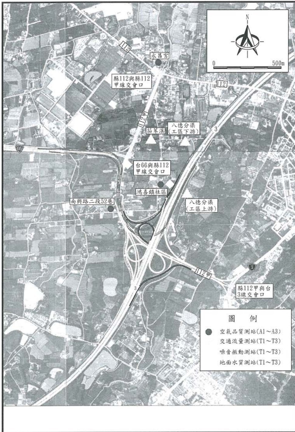
圖 1.4-1 「國道 3 號銜接台 66 線增設系統交流道工程」各類監測點位置示意圖
