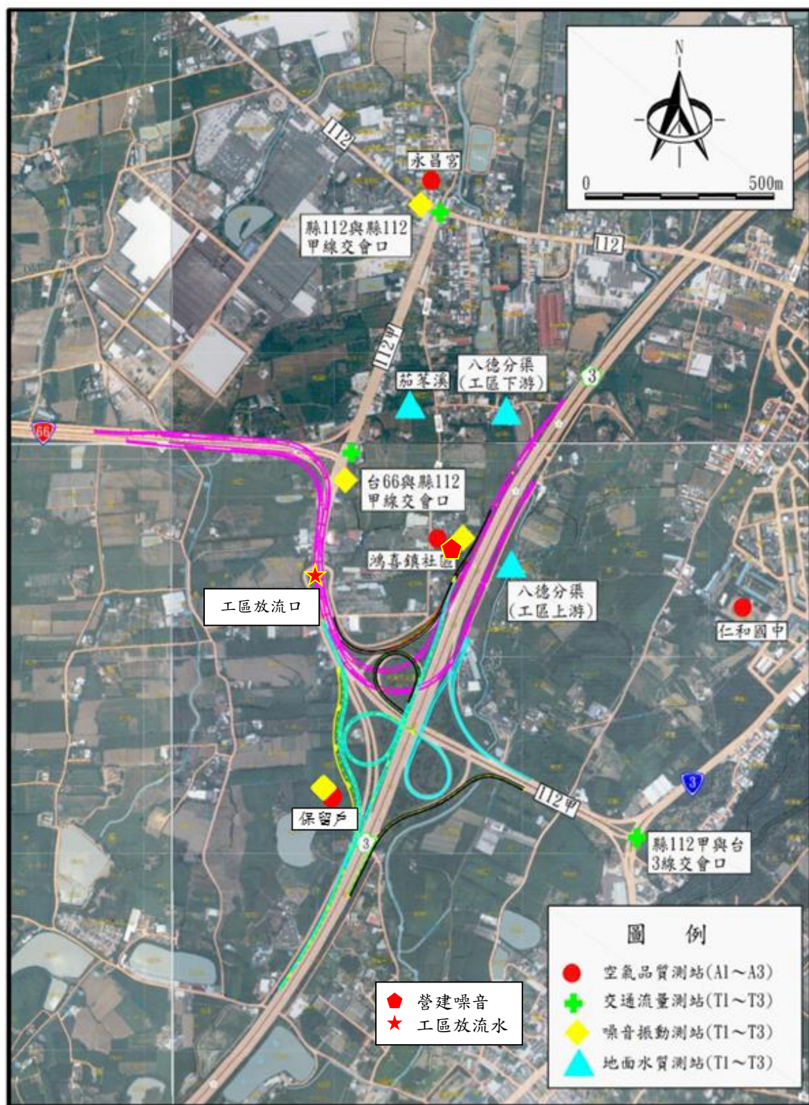
圖 1.4-1 『國道 3 號銜接台 66 線增設系統交流道工程』 各類監測點位置示意圖
