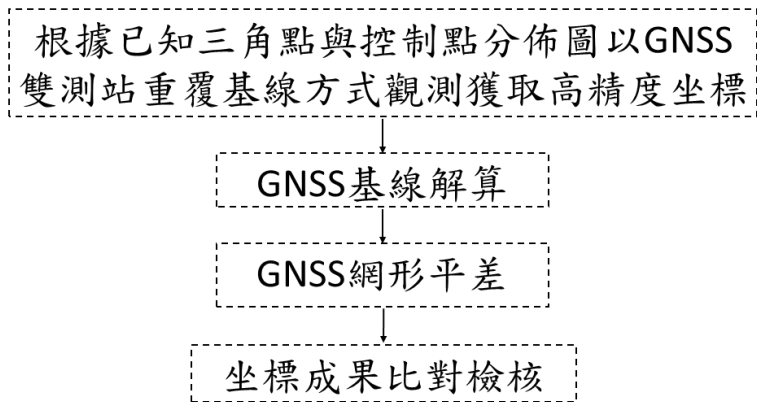
圖 2.11-3 GNSS 靜態觀測作業流程
