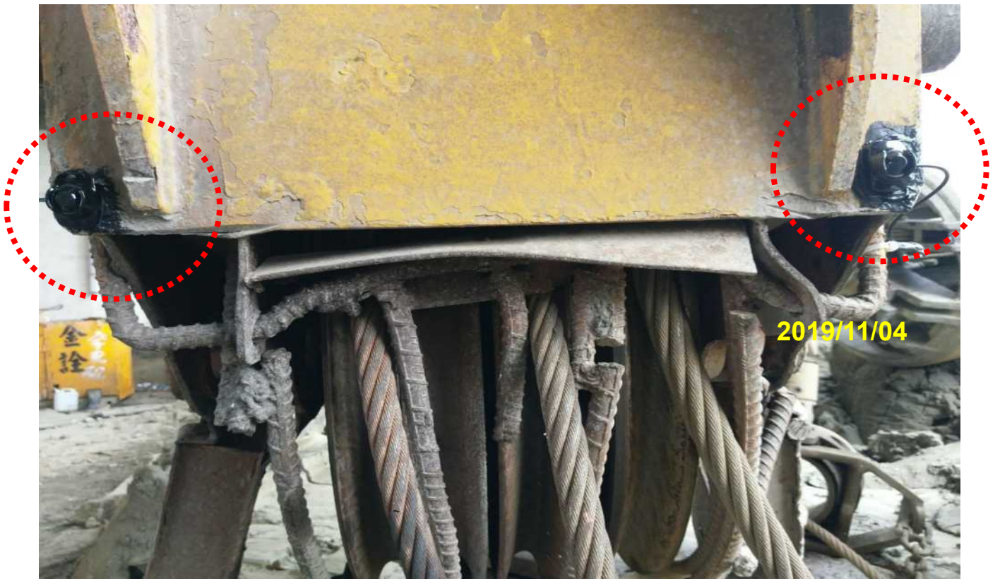
圖10、於吊臂上方裝設距離感測器警示操作人員 A
