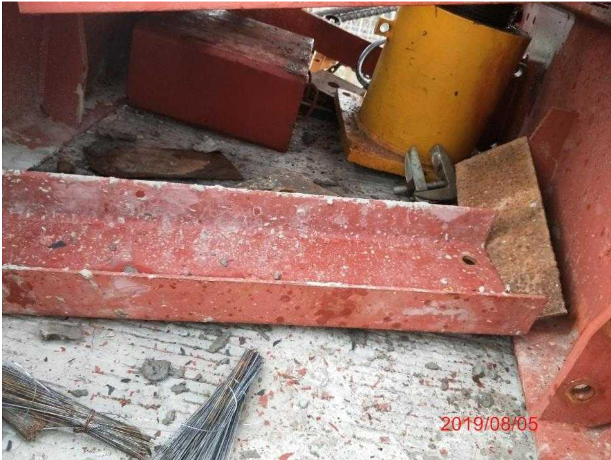
圖3、西側 A 架主千斤頂墊塊滑脫
