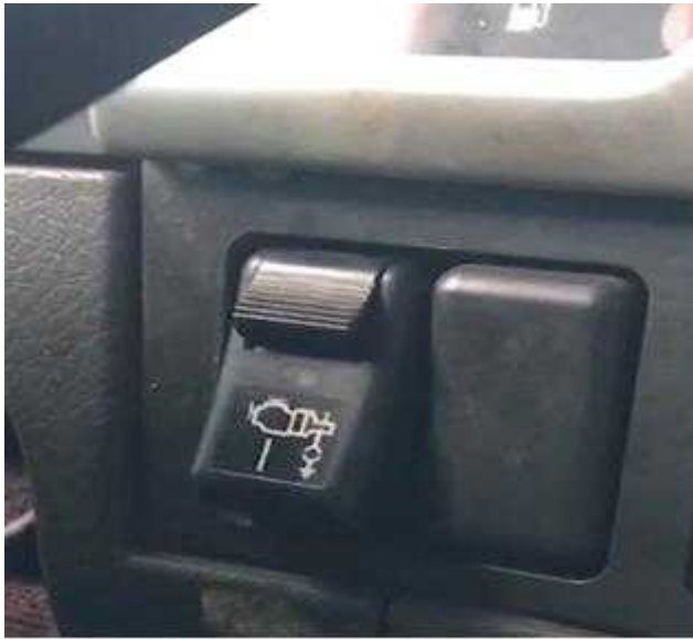
圖3、車內建置車斗舉升警示蜂鳴器
