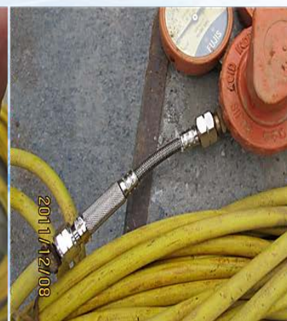
◎ 防回火裝置 / 鋼瓶保護套筒 / 提供物質安全資料表。
