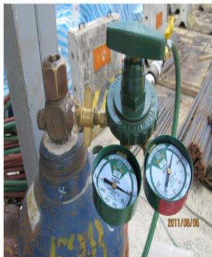
◎氧氣乙炔鋼瓶未分隔貯存 / 壓力計破損+皮管老化龜裂 / 鋼瓶任意棄置。
