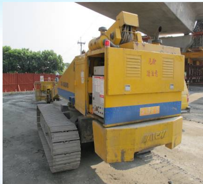
◎輪式-剪刀式-履帶式高空工作車/旋轉警示燈及蜂鳴器/機身控制鈕
