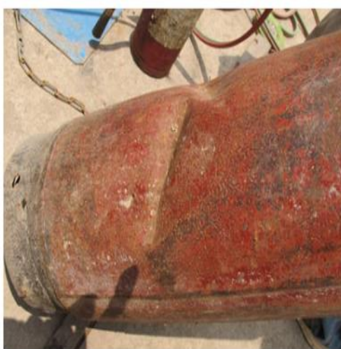
◎鋼瓶直立或倒置使用未固定且未裝防回火裝置 / 鋼瓶變形。
