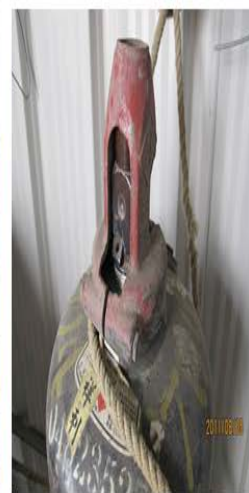
◎ 防回火裝置 / 鋼瓶保護套筒 / 提供物質安全資料表。
