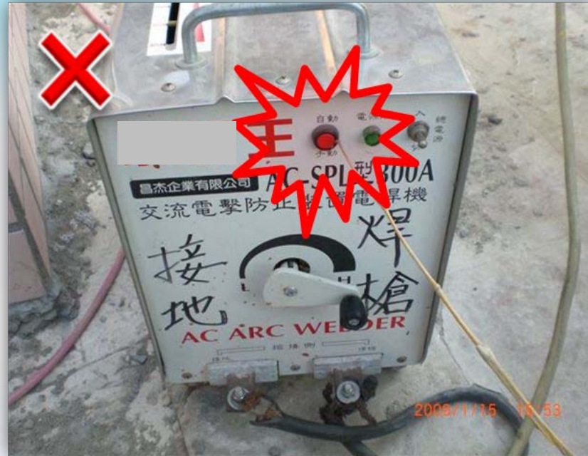
◎禁止自動電擊防止裝置測試鈕以固定物、牙籤或竹子等異物卡死，造成功能失效。
