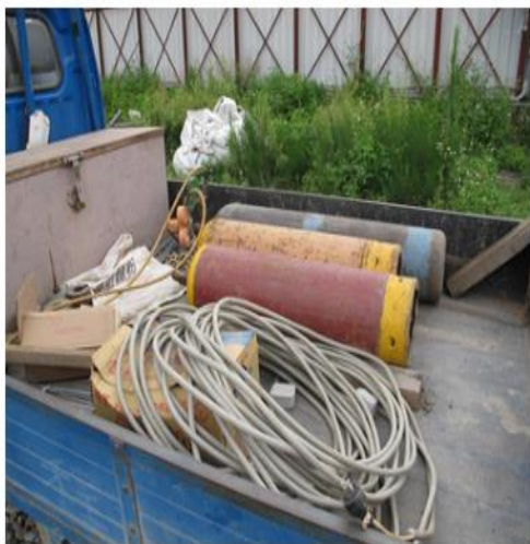
◎鋼瓶直立或倒置使用未固定且未裝防回火裝置 / 鋼瓶變形。
