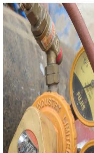
◎ 防回火裝置 / 鋼瓶保護套筒 / 提供物質安全資料表。
