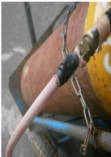
◎氧氣乙炔鋼瓶未分隔貯存 / 壓力計破損+皮管老化龜裂 / 鋼瓶任意棄置。
