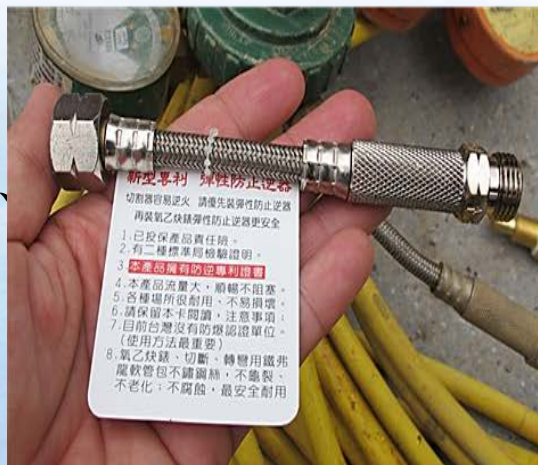
◎ 防回火裝置 / 鋼瓶保護套筒 / 提供物質安全資料表。
