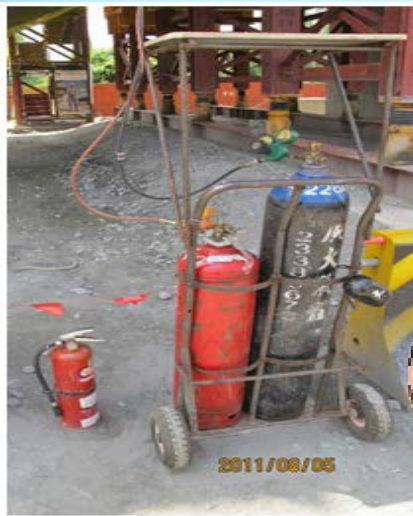
◎氧氣乙炔鋼瓶儲存區 / 搬運架(推車)+滅火器+簡易遮陽板
