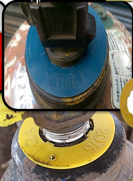
鋼瓶檢驗有效年限套環 (識別環六種顏色循環使用)
