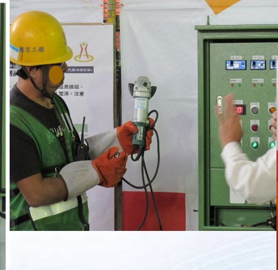
手工具/電焊機/電器延長線漏電測試
