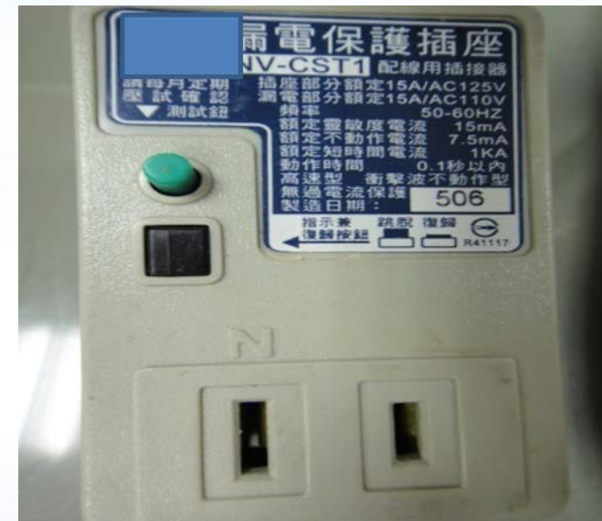
◎使用插座型漏電斷路器
