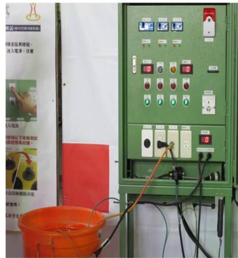
手工具/電焊機/電器延長線漏電測試
